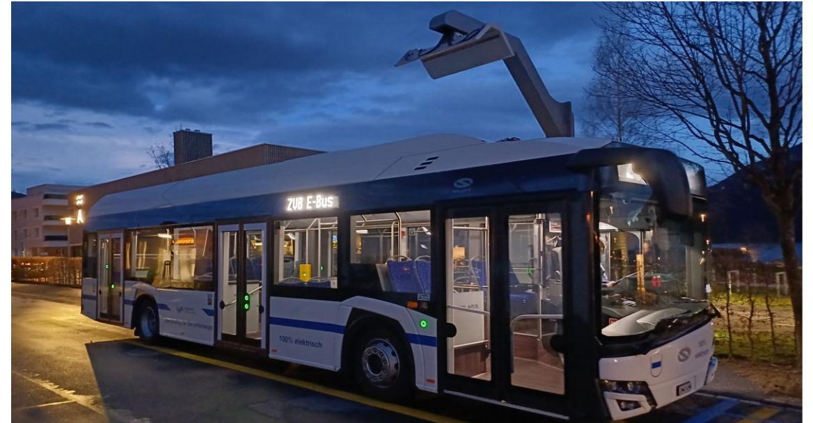
Gelegenheitsladung bei Schnell-Ladepunkt an Endhaltestelle
